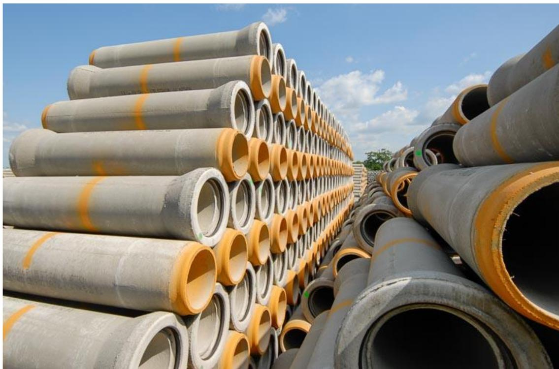
Tuyaux, regards, caniveaux, bouches d'engouffrement sont autant d'éléments par définition réalisés hors site... [©ACPresse]
