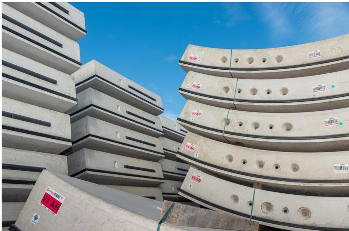
Pour le tunnel du lot 1 de la ligne 18 du Grand Paris Express, l'industriel Stradal a fourni des voussoirs réalisés en béton très bas carbone et même ultra-bas carbone Exégé de Vinci Construction. [©ACPresse]
