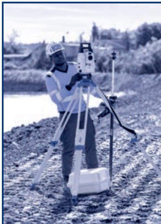
**Aluisio se rend sur la zone inexplorée par les équipes et installe son théodolite (instrument de mesure). Il collecte les distances, les angles horizontaux et verticaux nécessaires à l'établissement des plans. Il faut être le plus précis possible pour permettre aux équipes de terrasser le bon volume de terre et ainsi respecter le planning et le cadre budgétaire.**
