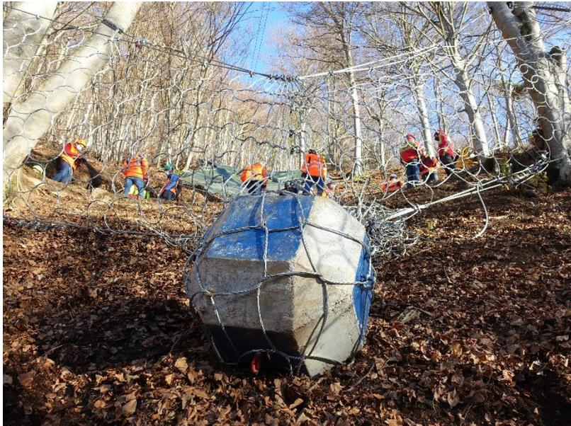
Conçue et testée en conditions réelles, cette innovation proche des exigences du Document d'Evaluation Européen sur les kits de protection contre les éboulements et a démontré son efficacité en lieu et place d'un écran pare-blocs traditionnel.
